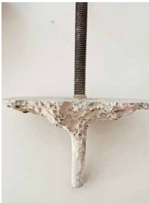
Rottura del calcestruzzo combinata con sfilamento di un ancorante chimico
