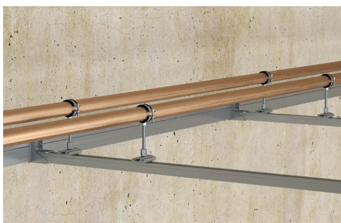
Linee di distribuzione con dilatazione termica
